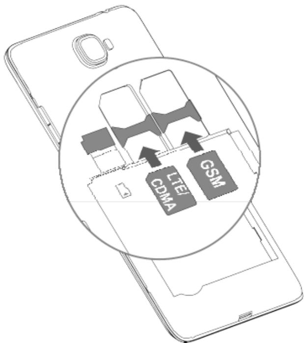
3. 将存储卡放入卡槽（您可能需要额外购买存储卡），如下图所示。
